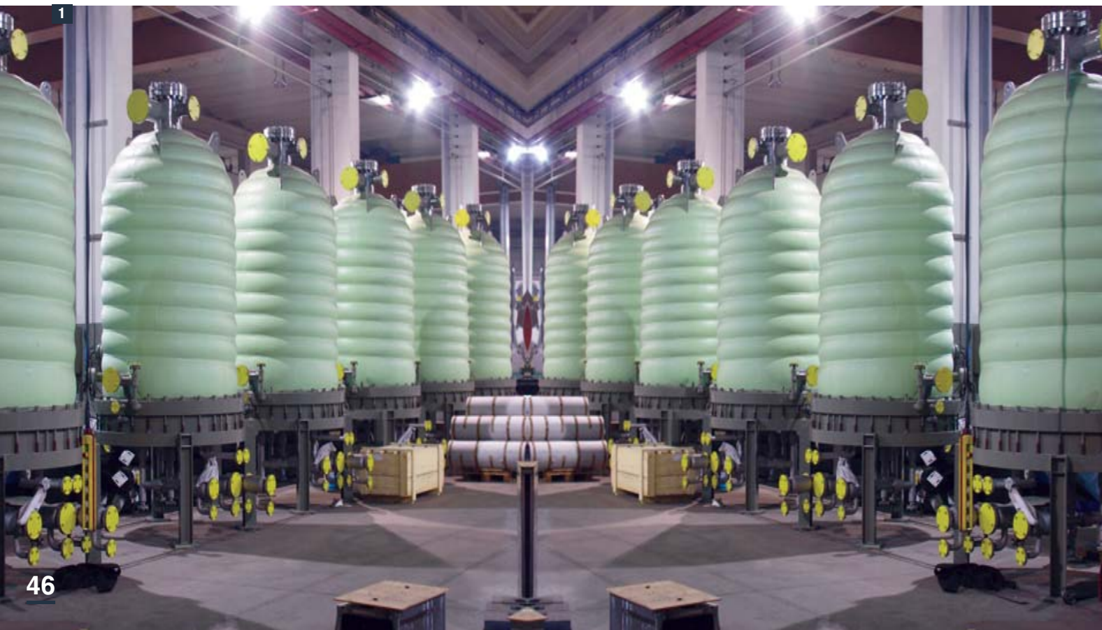
1 CVD Reactor, 36 rods, SA 516 70 Cladded SA 230-304, SETEK, Japan
