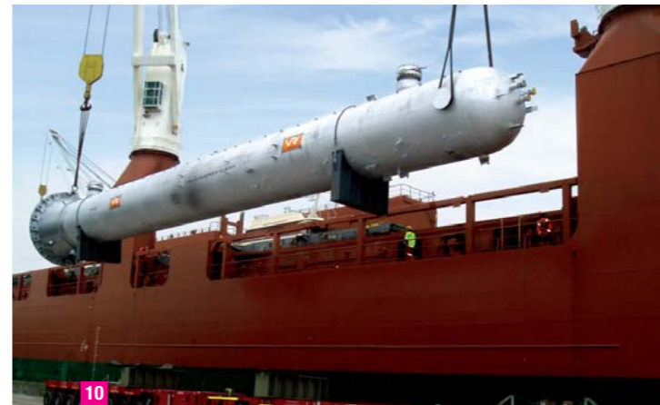
9 H2S Absorber (190 ton), 1.25 Cr alloy w/ 347 SS.W.O., Tecnicas Reunidas - Galp Energia, Sines Portugal
